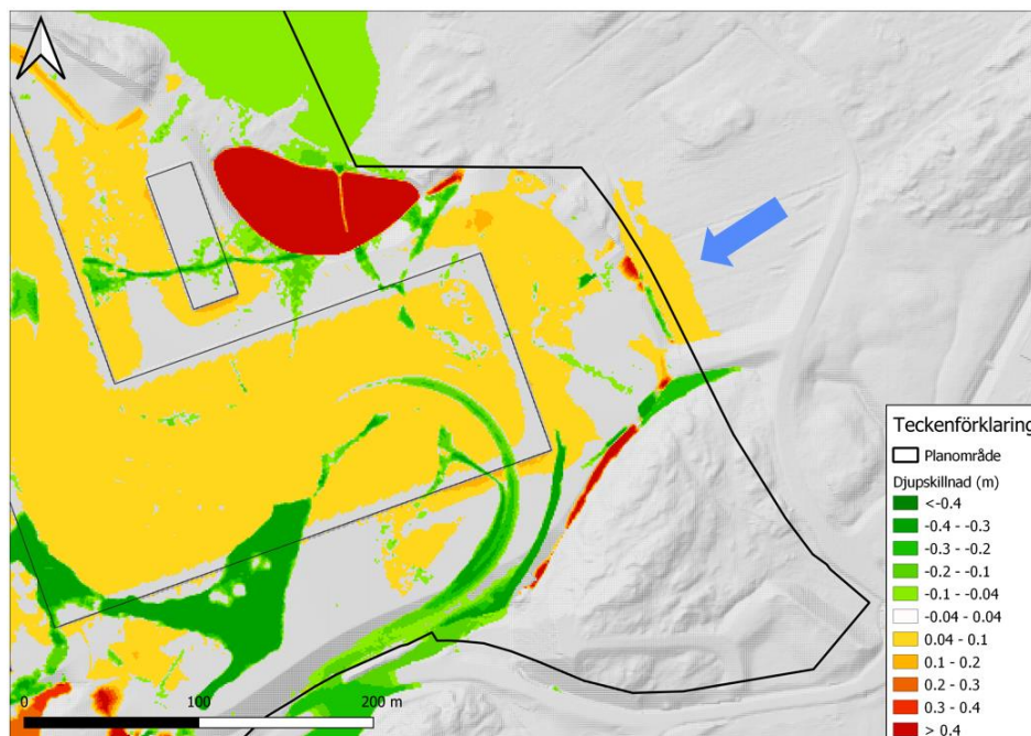
Figur 44. Förändrat maximalt vattendjup (m) i framtida situation med åtgärder jämfört med befintlig situation inom Gamla Sörredsvägen. Negativa värden (gröna nyanser i figuren) betyder lägre vattendjup i framtiden medan gul/röda färger betyder högre vattendjup i framtiden. Blå pil visar flödesriktning utanför planen.
