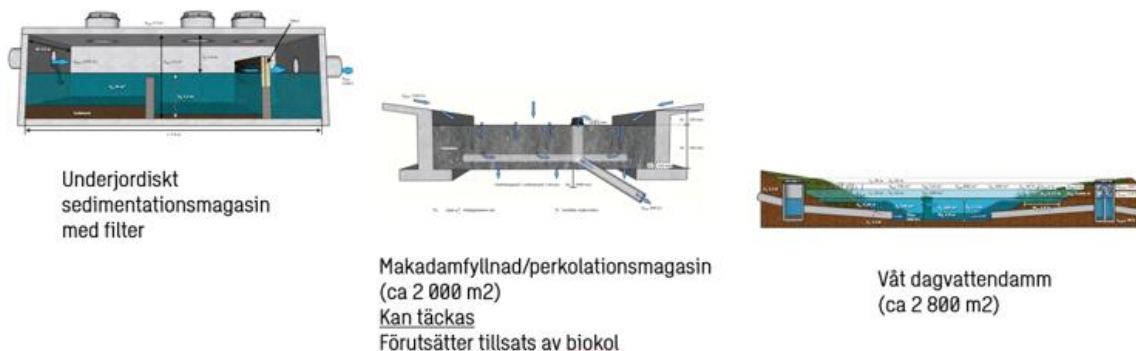
Figur 32 Föreslaget system för dagvattenrening för att inte begränsa möjligheterna att uppnå miljö kvalitetsnormerna.
